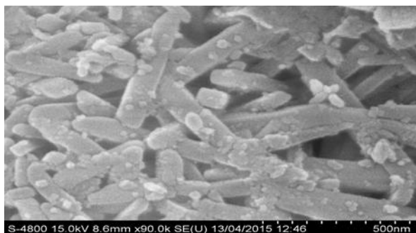
Fig. 6 SEM of ZSM5
